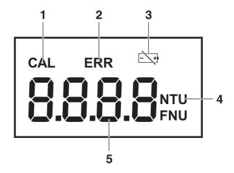
Symbole de calibration - appareil sur le mode de calibration
